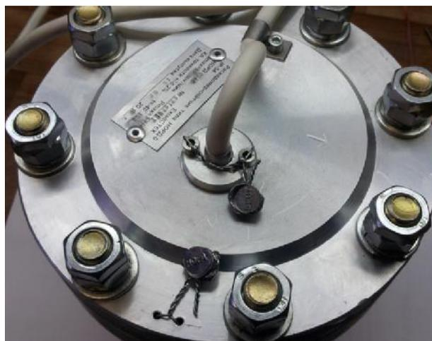
Рисунок 7 – Места пломбировки первичных преобразователей НОРД-О-В
