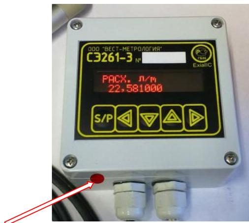
Рисунок 5 – Место пломбировки счетчика электронного СЭ-261
