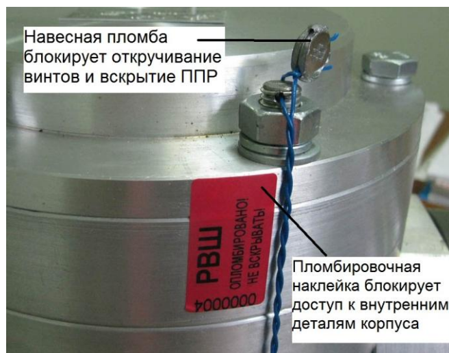
Рисунок 4 – Схема пломбировки ППР расходомера НОРД-ТА
