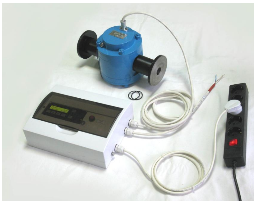
Фото 2 – Пример использования СКЭ-01 совместно с ППР роторного расходомера
